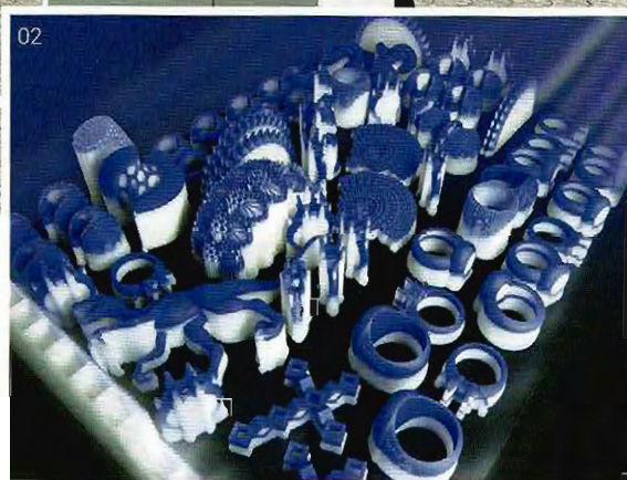
01 Das Team von Horbach hält 3D-Drucker für die unterschiedlichsten Anforderungen und Budgets parat. Für große Produktionsvolumina eignen sich die WachspLOTter „ProJet MJP 2500W“ von 3D Systems im Vordergrund 02 Die Bauplatte des „MJP 2500W“ bietet mit 300 mal 200 Millimetern riesige Kapazitäten
