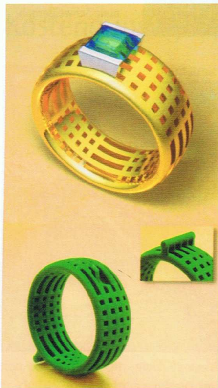
Nach Freigabe des digitalen Entwurfs (oben), wird das Gießmodell erstellt (unten).
